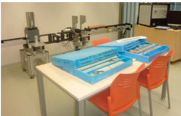
Multisensor Core Logger disposat per analitzar testimonis de sondatges.
