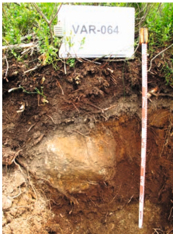
Pèdon VAR-064. Seqüència d'horitzons: Oi-Oe-Oa-E-Bsh1-Bsh2-Bsh3-Bsh4. Monografia de sòls de la comarca de la Val d'Aran (DAAM-IGC, 2014).
