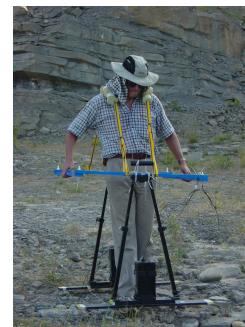
Figura 2 – Vehículo diseñado para facilitar el transporte de las antenas. En modo continuo el tiempo de adquisición de datos se reduce a una tercera parte.
